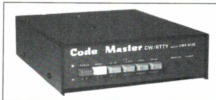
CWR-610 E f 698,- Compacte en eenvoudige telex-morse converter, geschikt voor normale TV of monitor, ingebouwde morse oefengenerator.
